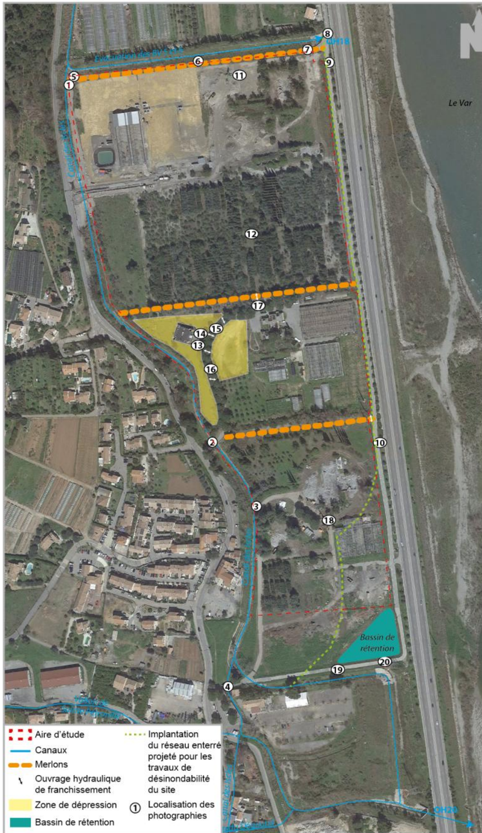
Figure 107 - Fonctionnement hydraulique du site
